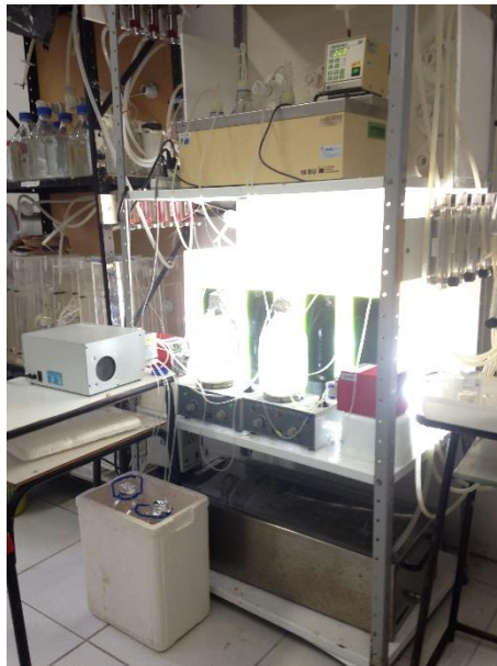
Figura 4.7 – Sistema integrado entre fotobiorreatores e fermentadores de cerveja.
