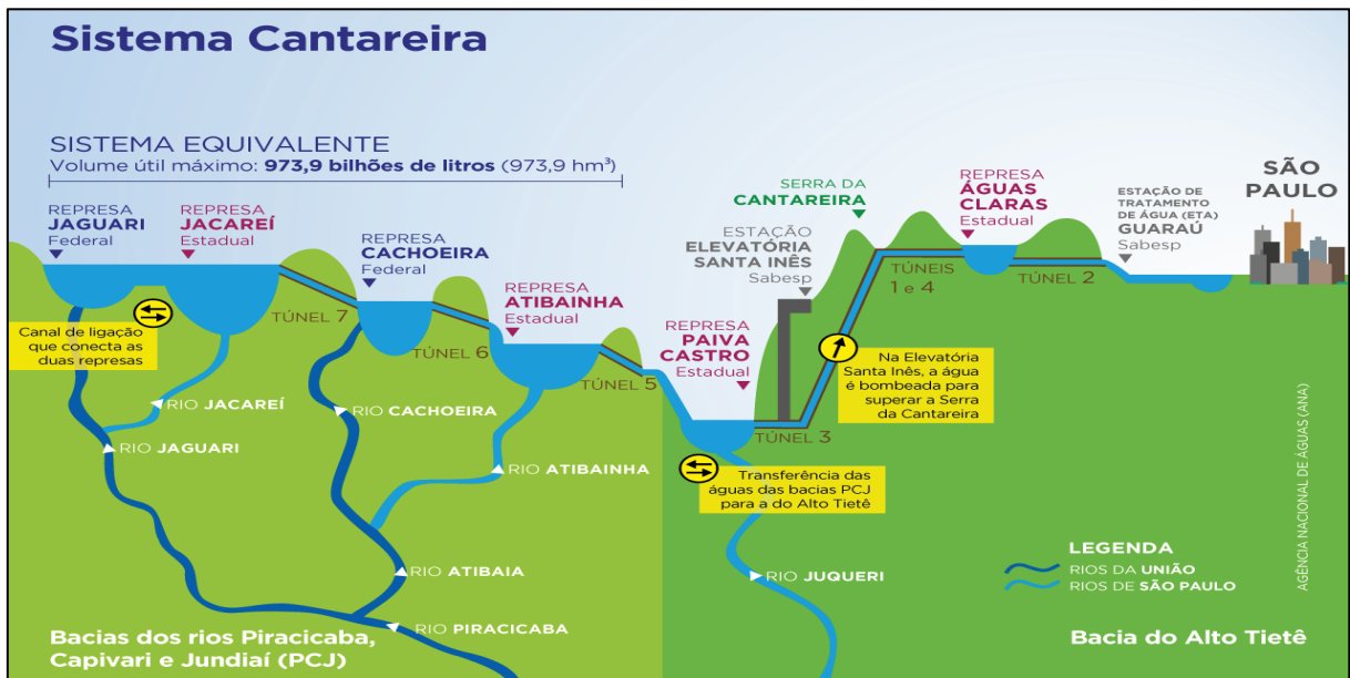
Figura 4. Esquema representativo do Sistema Cantareira.
