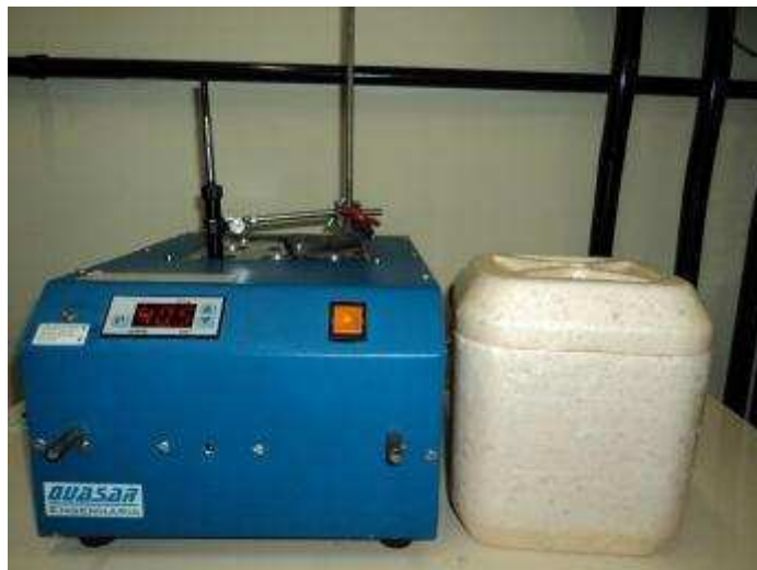
Figura 4: Montagem empregada para realização das HS-SPME de compostos voláteis de vinhos espumantes em bloco termostático. Fonte: Autor.
