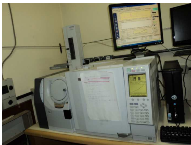
Figura 5: Cromatógrafo gasoso com detector quadrupolar de espectrometria de massas da marca Shimadzu, modelo QP2010 Plus, onde foram realizadas as análises dos compostos voláteis dos vinhos. Fonte: Autor.
