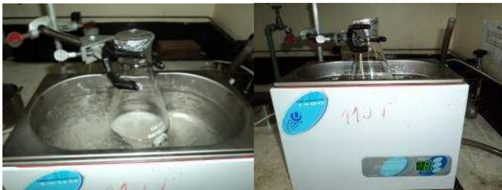
Figura 3: Aparato utilizado para desgaseificação de amostras de espumantes em banho de água e gelo em um ultrassom da empresa Unique Group, São Paulo. Fonte: Autor.
