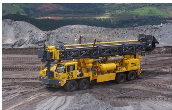
Figura 9 – Perfuratriz DTH Atlas Copco
