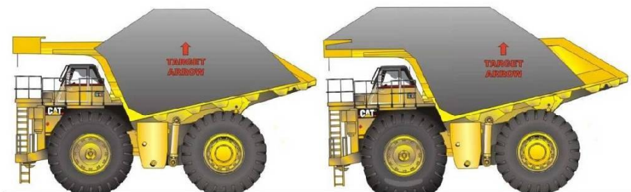
Figura 20 - Distribuição da carga frontal
