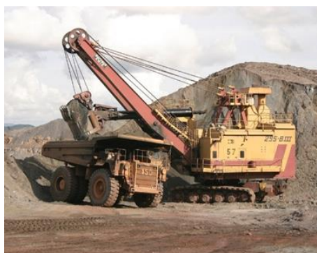
Figura 15. Escavadeira à cabo
