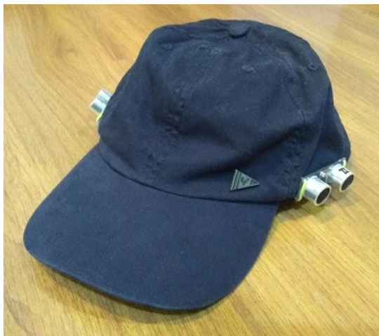
Figura 32 – Boné com sensores laterais.
