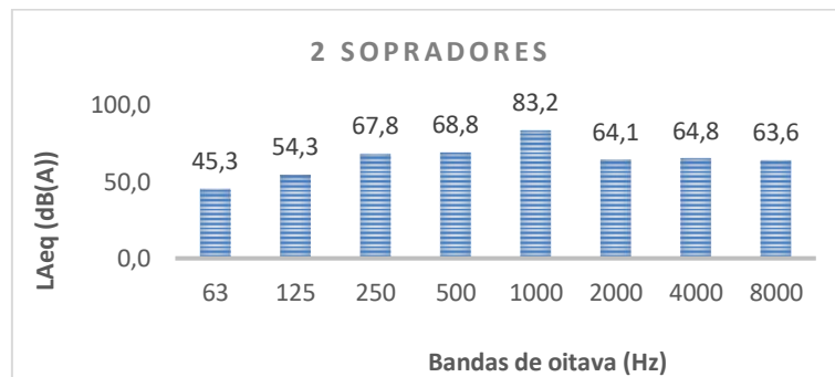
Figura 5.4 - LAeq para dois Sopradores do Tratamento Preliminar ligados.
