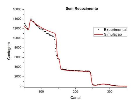
Fig. 4.6: espectro de RBS de SiO<sub>2</sub> com implantação de Ga e de O, sem recozimento.
