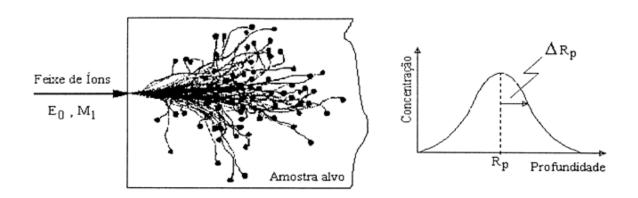
Fig. 3.1: ilustração do processo de implantação iônica.
