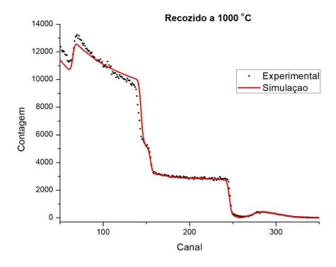
Fig. 4.9: espectro de RBS de SiO<sub>2</sub> com implantação de Ga e de O, recozido a 1000 °C.
