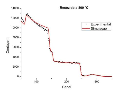
Fig. 4.8: espectro de RBS de SiO<sub>2</sub> com implantação de Ga e de O, recozido a 800 °C.
