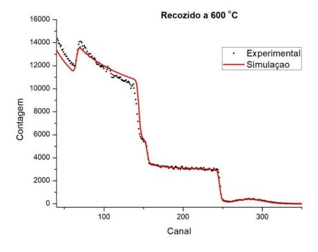
Fig. 4.7: espectro de RBS de SiO<sub>2</sub> com implantação de Ga e de O, recozido a 600 °C.
