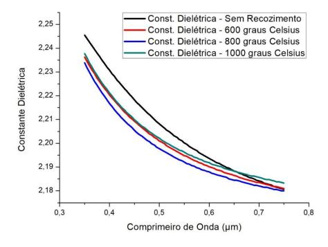
Fig. 4.10: valores da constantes dielétricas para as amostras de Ga<sub>2</sub>O<sub>3</sub> em SiO<sub>2</sub> na faixa de comprimento de onda entre 350 e 800 nm.
