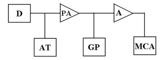
Fig. 3.2: diagrama em blocos do sistema analisador de um experimento de RBS, onde D é o detector de partículas retroespalhadas, AT é a fonte de alta tensão, PA é o pré-amplificador, GP é um gerador de pulsos para a verificação da estabilidade do sistema eletrônico, A é o amplificador e MCA é o analisador multicanal que armazena contagens nos seus respectivos canais, seguindo uma relação linear com a energia da partícula coletada.
