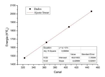
Fig. 4.3: curva de calibração para as medidas de RBS.
