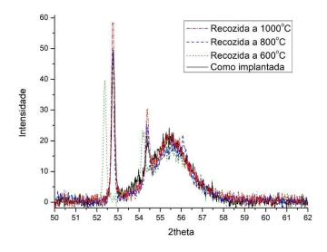
Fig. 4.12: difratogramas de GIXRD sem deslocamento vertical, mostrando o crescimento dos picos com a temperatura de recozimento.
