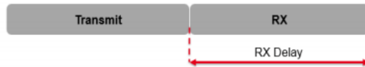
Figura 10 - Representação do envio e recebimento de mensagens de dispositivos LoRa de classe C.
