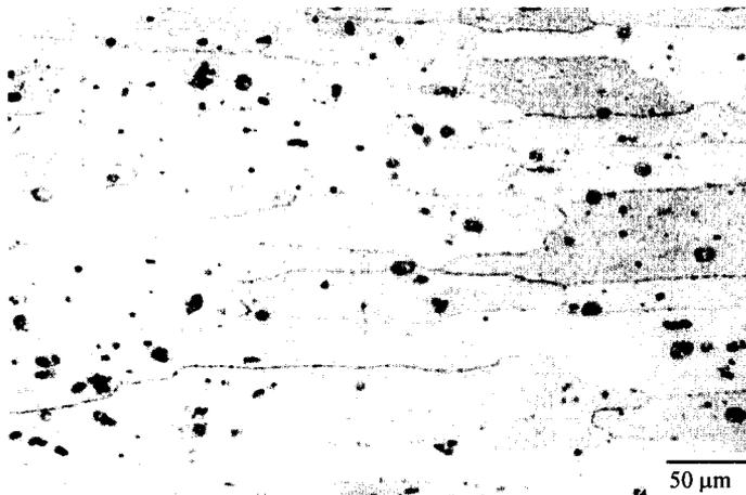
**Figura 36** – Micrografia da zona afetada termicamente onde observam-se os grãos alongados do material na condição T6 que foi soldado com a condição P2. Ataque: Reagente Flick.
