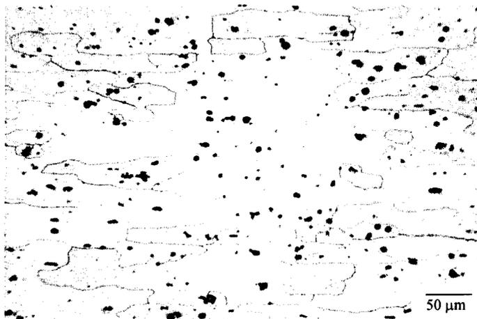
**Figura 25** – Micrografia do material base do material na condição T4 que foi soldado com a condição P1. Ataque: Reagente Flick.
