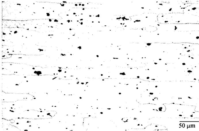
**Figura 26** – Micrografia retirada na região do material base material na condição T4 que foi soldado com a condição P2 mostrando os grãos alongados. Ataque: Reagente Flick.
