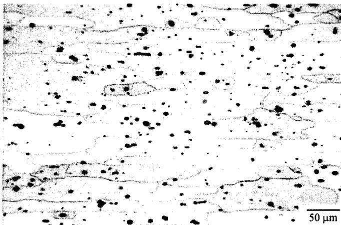
**Figura 29** – Micrografia do material base mostrando o material na condição T6 que foi soldado com a condição P1. Observam-se grãos alongados e as inclusões dispersas na matriz  $\alpha$ . Ataque: Reagente Flick.
