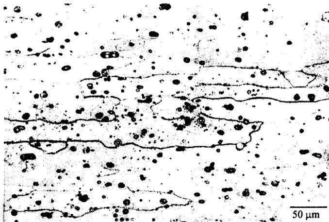
**Figura 33** – Micrografia retirada da zona afetada termicamente (ZAT) material na condição T4 que foi soldado com a condição P1 e após isto, foi tratado termicamente para a condição T6. Ataque: Reagente Flick.
