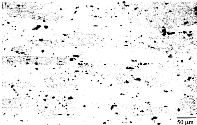
**Figura 31** – Micrografia obtida material na condição T4 que foi soldado com a condição P1 na zona afetada termicamente (ZAT). Observam-se os grãos alongados e a fase escura correspondente as inclusões dissolvidas. Ataque: Reagente Flick.
