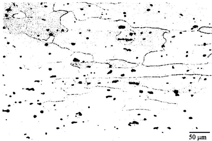
**Figura 35** – Micrografia da zona afetada termicamente do material na condição T6 que foi soldado com a condição P1. Ataque: Reagente Flick.
