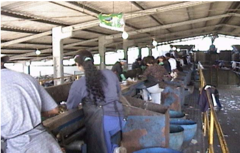
Figura 1: Esteira de catação.
