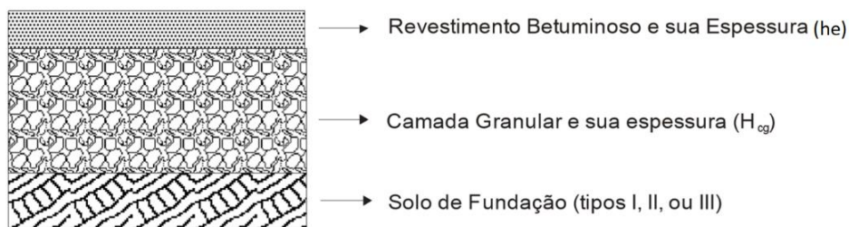
Figura 13 - Estrutura de referência TECNAPAV
