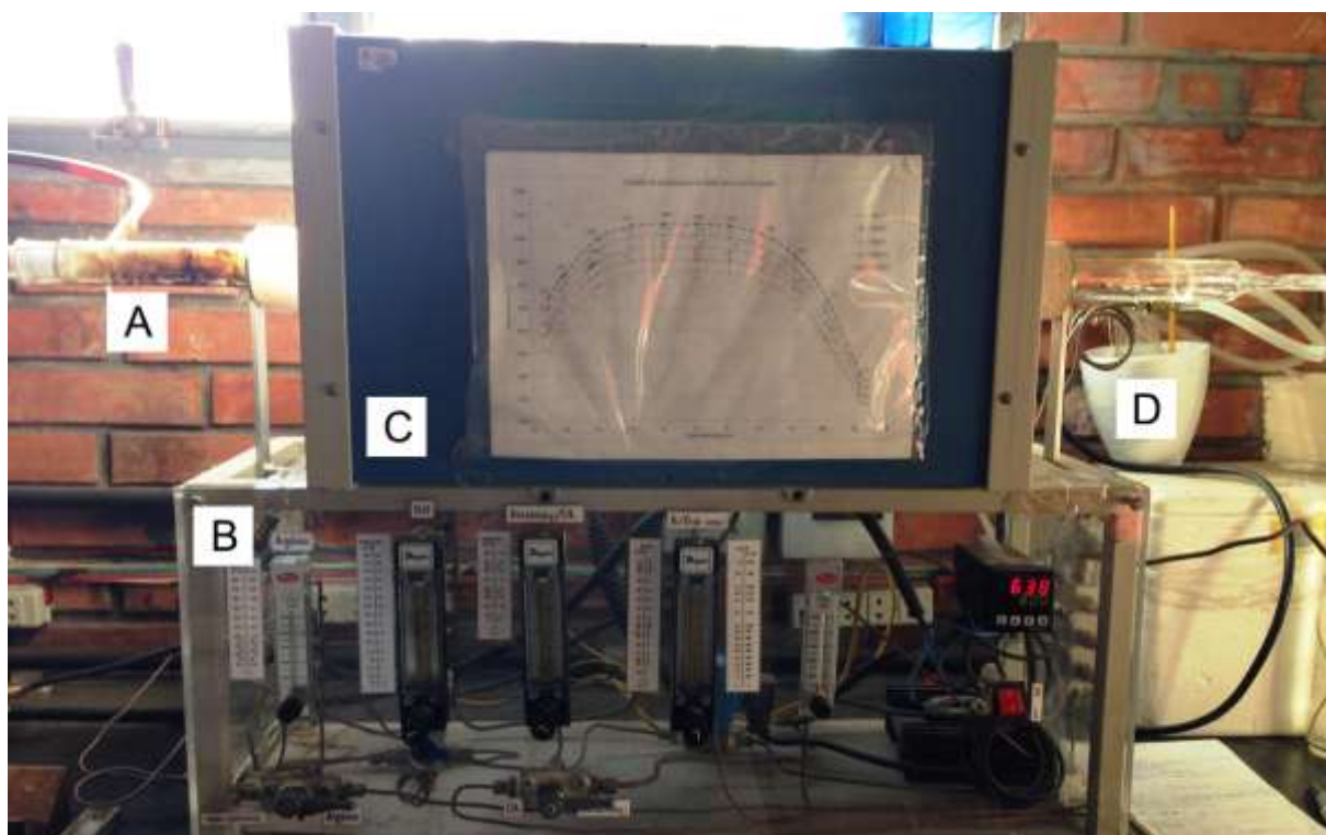
Figura 27: Reator CVD utilizado na deposição dos NTCs. (A) Tubo de quartzo, (B) controladores de fluxo de gases, (C) forno elétrico tubular, (D) borbulhador com precursor de carbono.
