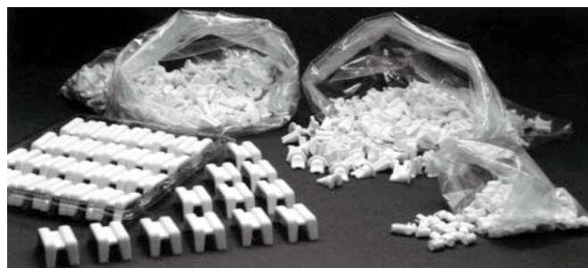
Figura 5: Guia-fios sinterizados com parede fina produzidos por MIBP em grande quantidade. [Figure 5: Sintered thread-guides with thin cross-section produced in large quantities by LPIM.]
