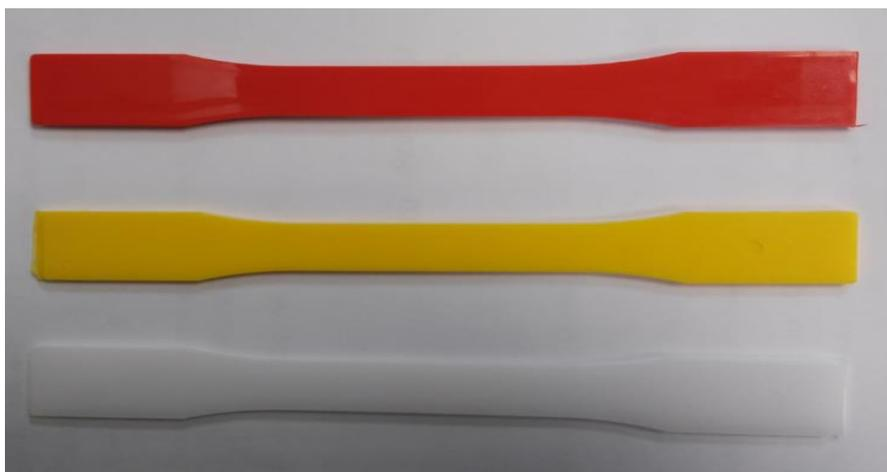
**Figura 14.** Corpos de prova de PEAD após o processo de injeção.
