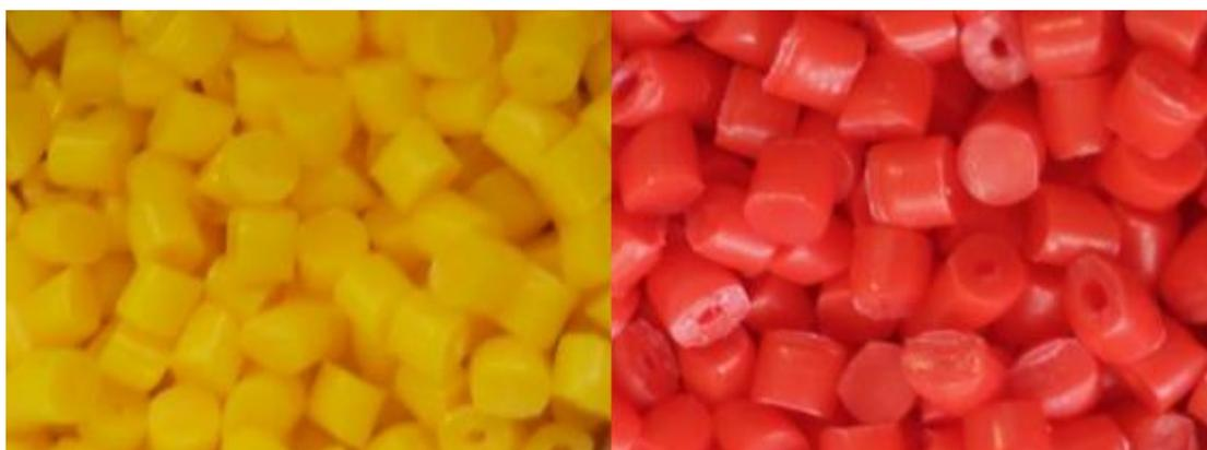
**Figura 13.** Grânulos de PEAD + masterbatch após o processo de extrusão e granulação.
