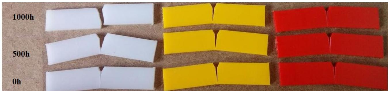
**Figura 24.** Corpos de prova após o ensaio de impacto Izod a 23°C, conforme o tempo de envelhecimento.
