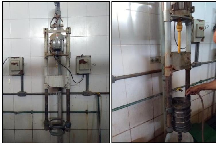
Figura 9. Peneiramento à úmido.
