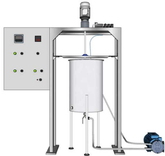
Figura 20. Tanque de preparação de polpa que alimenta o condicionamento.
