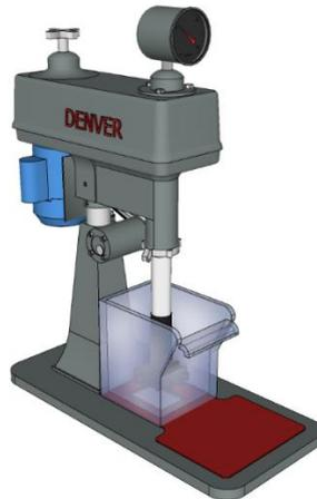
Figura 16. Máquina de flotação mecânica *Denver*, modelo D12 do CETEM utilizada nos ensaios de flotação de calcita em escala de bancada (configuração *rougher/cleaner/recleaner*).
