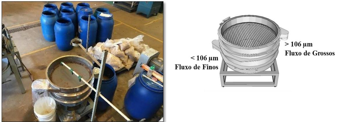
Figura 12. Peneiramento a úmido em escala piloto.
