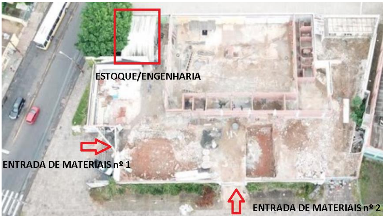
Figura 11 - Layout do canteiro de obras
