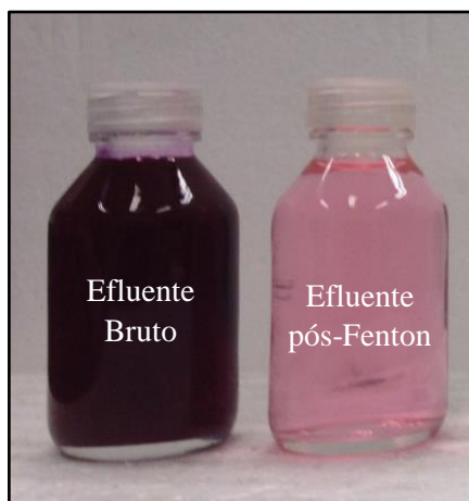
Figura 13 - Aspecto visual do efluente bruto (esquerda) e do efluente tratado pela reação de Fenton (direita) com concentração de reagentes referente à 20 mL.L -1 de H 2 O 2 35%.
