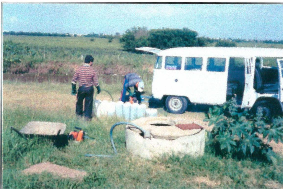
Figura 4.6 - Detalhe da coleta de lixiviado no Aterro Sanitário Zona Norte (DMLU)
