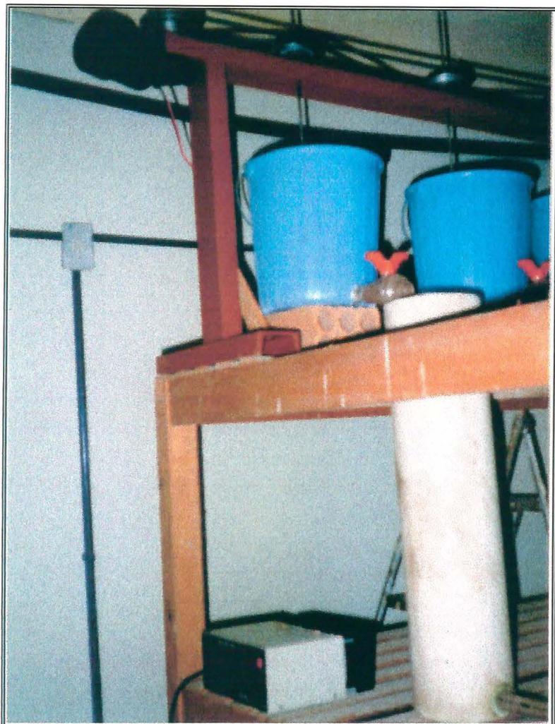
Figura 4.2 - Sistema misturador eletro-mecânico com controle de velocidade
