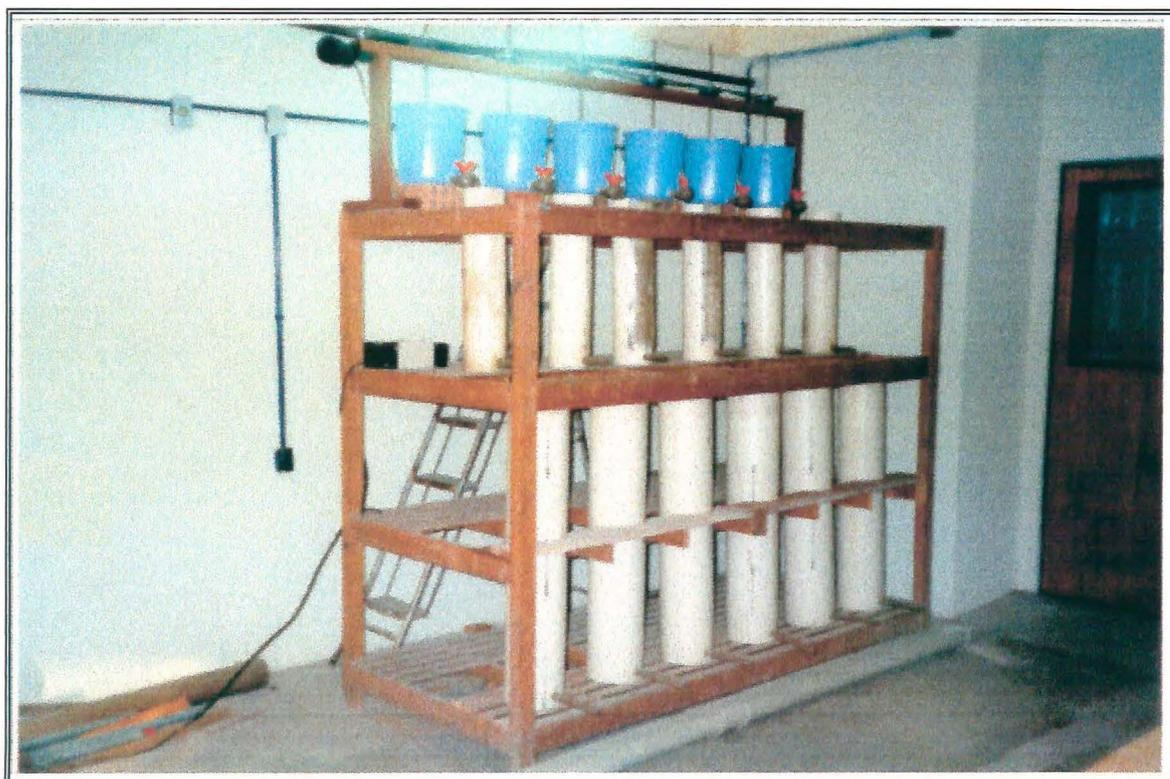
Figura 4.1 - Vista geral do sistema filtrante
