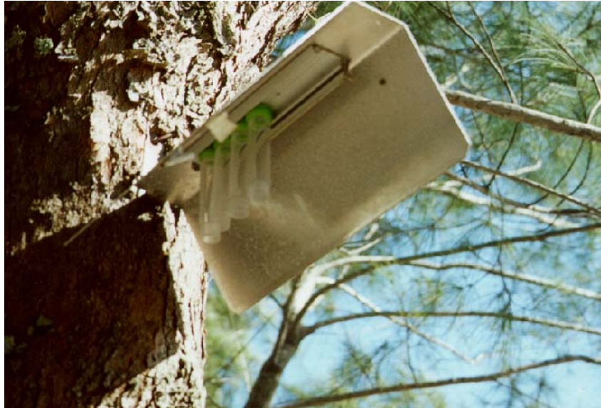
Figura 3. Amostradores de Dióxido de Nitrogênio (NO 2 ), "Palme Tubes".
