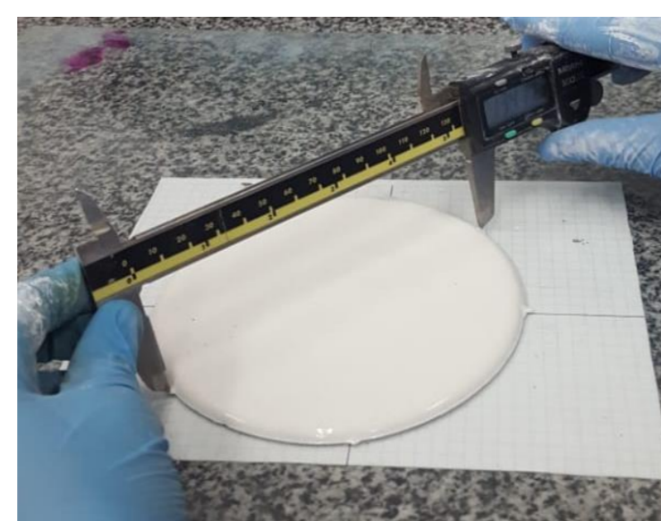
Figura 3 – Medição do diâmetro do mini-slump de uma pasta de cal
