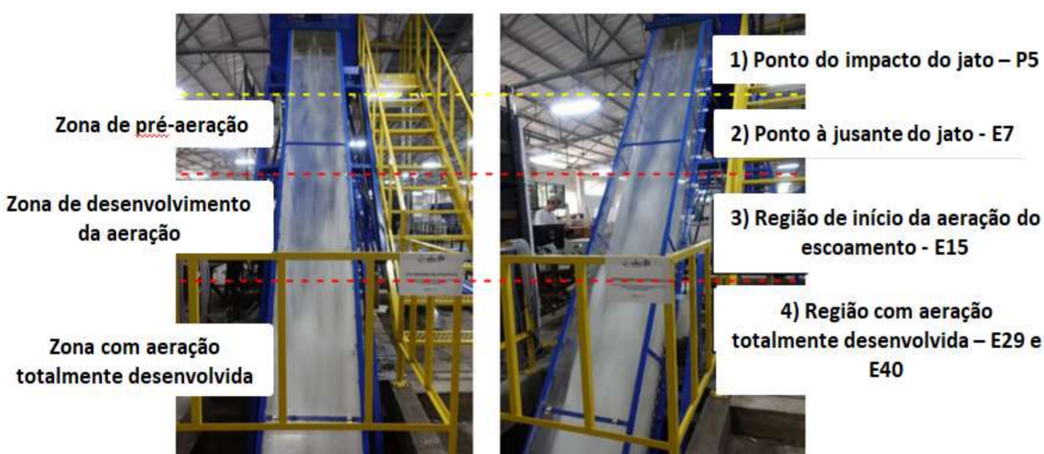
Figura 1 – Ensaio sendo realizado no modelo físico reduzido localizado no LOH – UFRGS, a subdivisão do escoamento e as posições analisadas.
