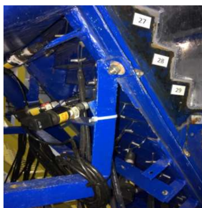
Figura 2 – Transdutor instalado no modelo.
