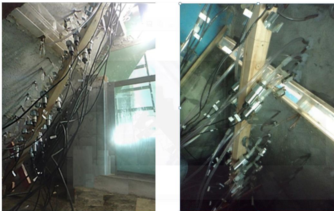
Figura 35- Transdutores instalados no modelo LAHE.
