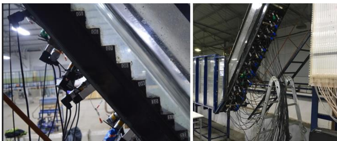
Figura 33 - Transdutores instalados no modelo LOH I.
