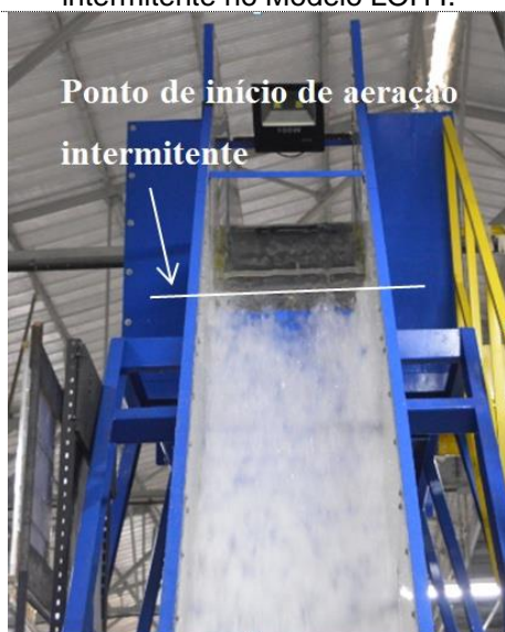
Figura 38 - Ponto de início da aeração intermitente no Modelo LOH II.
