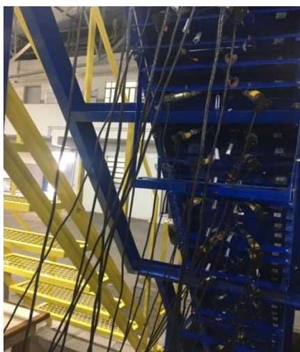
Figura 34 - Transdutores instalados no modelo LOH II.
