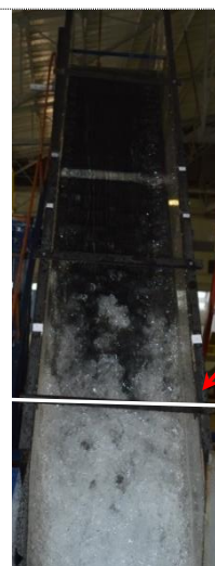
Figura 37 - Ponto de início da aeração total no Modelo LOH I.
