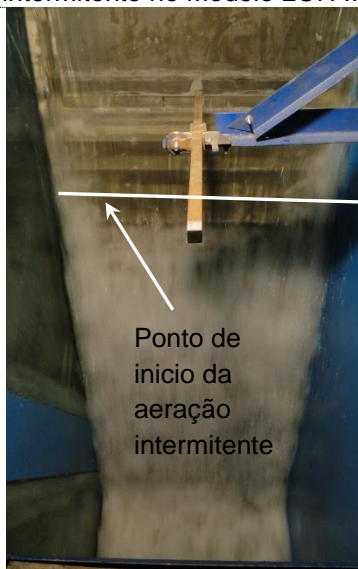
Figura 40 - Ponto de início da aeração intermitente no Modelo LAHE.
