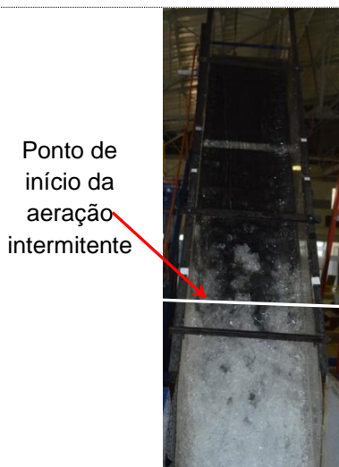
Figura 36- Ponto de início da aeração intermitente no Modelo LOH I.
