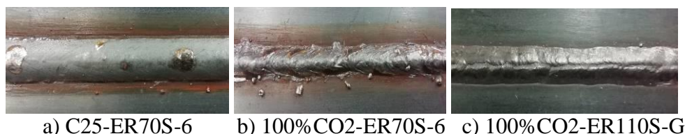
Figura 4.1. Qualidade da superfície das juntas soldadas nos CP a) 1, b) 2 e c) 8.
