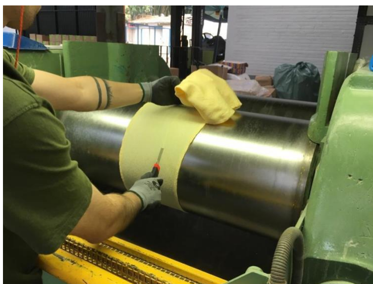
Figura 12 – Mistura da formulação no cilindro
