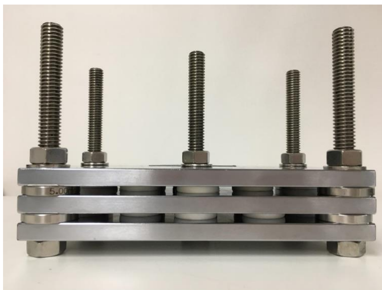
Figura 16 – Dispositivo de compressão
