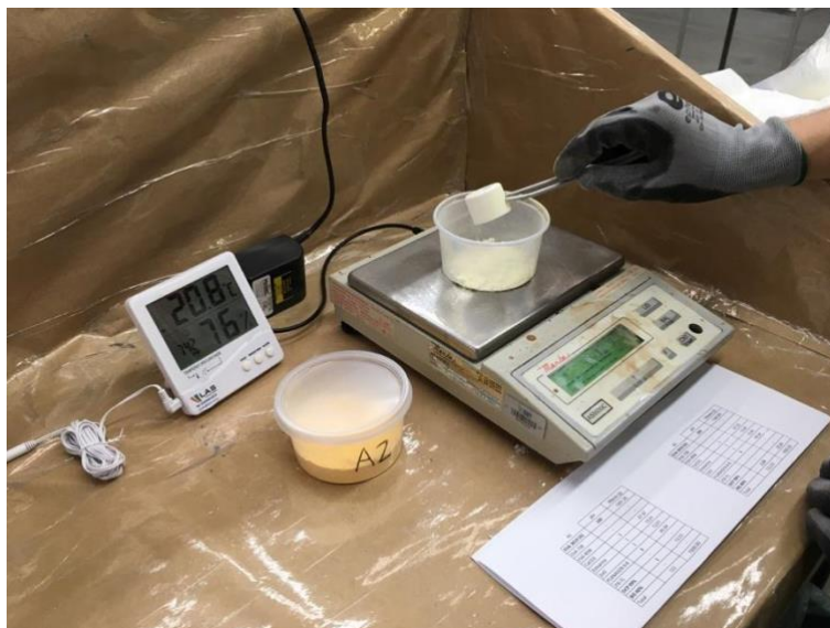
Figura 11 – Pesagem das matérias-primas
