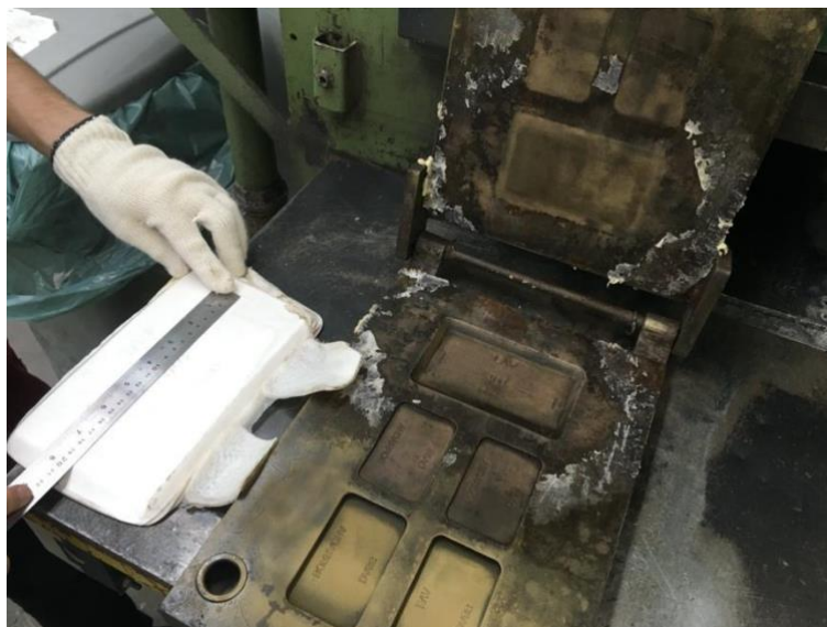
Figura 14 – Verificação da expansão à quente logo após abertura do molde
