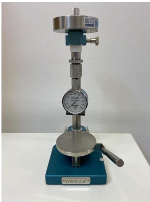
Figura 15 – Equipamento para ensaio de dureza
