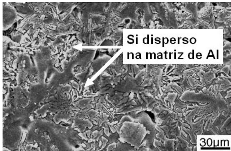
Figura 4.8: Morfologia superficial do revestimento de Al-Si (90% alumínio e 10% silício), com a formação de partículas de silício eutético na superfície do revestimento [23].
