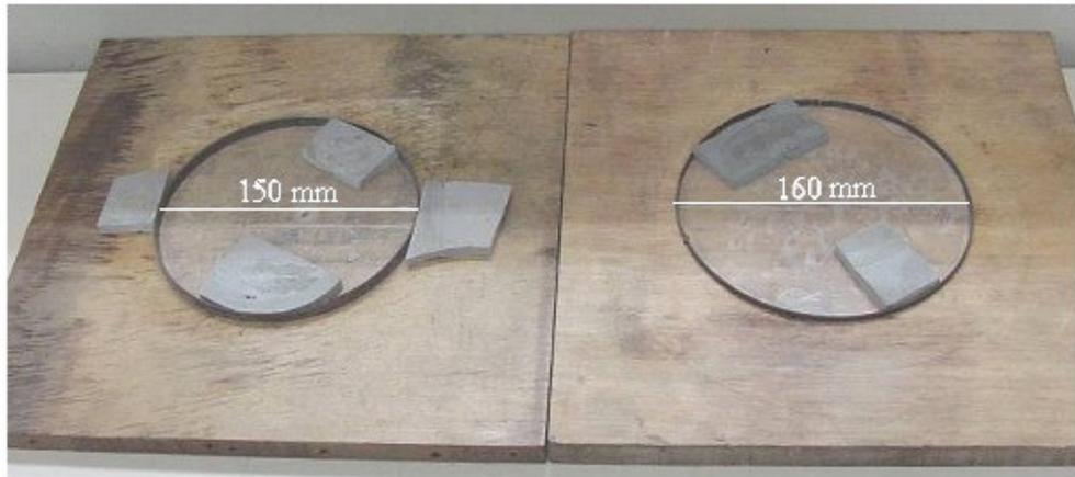
Figura 5.3: Ferramental de corte das camadas interna (tampa) e externa (bandeja).
