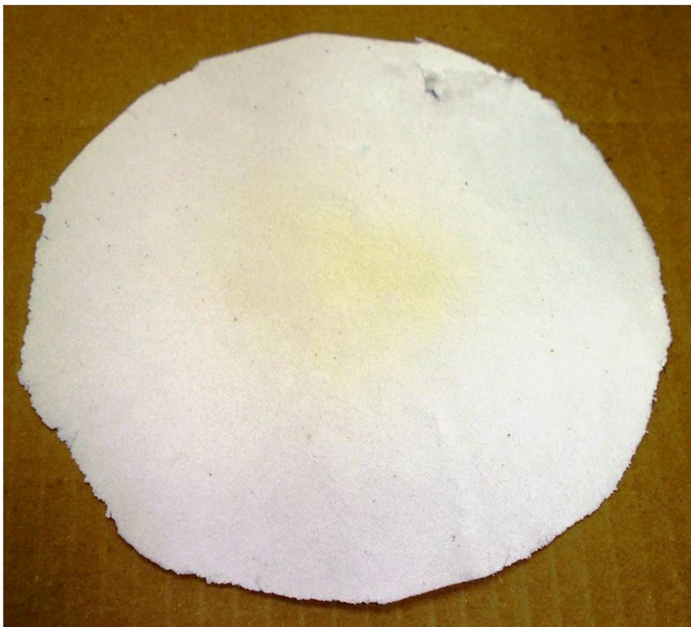
Figura 6.32 - Fiberfrax® (utilizado na camada intermediária da forma construtiva de 3 camadas) após o ensaio de resistência ao calor.
