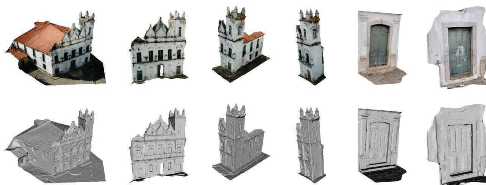
Figura 5 – Renderização em cores e suas respectivas malhas 3D após processamento no Autodesk ReCap Photo
