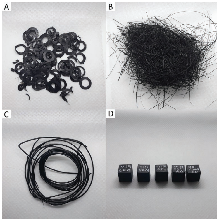
A) Discos de calibragem. B) Filamento extrudado purgado. C) Filamento extruído. D) Testagem de parâmetros.
