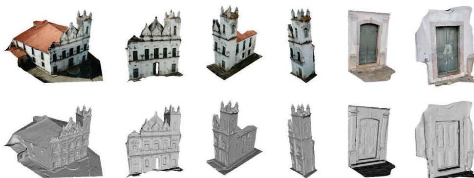
Figura 5 – Renderização em cores e suas respectivas malhas 3D após processamento no Autodesk ReCap Photo
