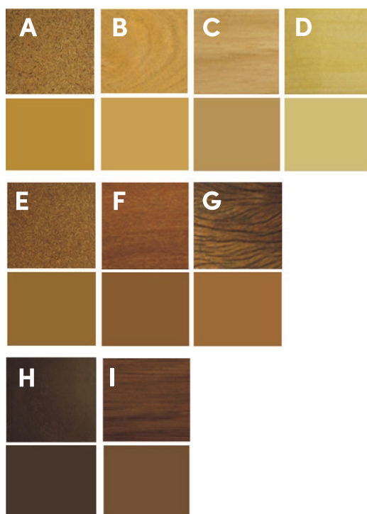
Figura 10 – Cores de madeiras próximas às cores dos compósitos com casca de arroz: A) PO/CAI, B) Cerejeira, C) Teca, D) Marfim, E) PO/CAIM, F) Cumaru, G) Madeira de demolição, H) PO/CAM, I) Imbuia.
