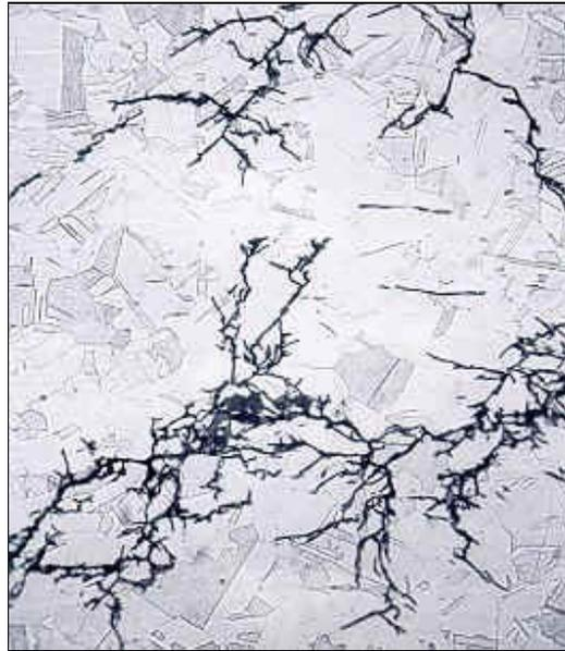
Figura 4 - Fratura Transgranular. 50X<sup>10</sup>
