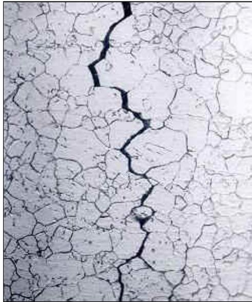
Figura 3 - Fratura intergranular. 500X<sup>10</sup>
