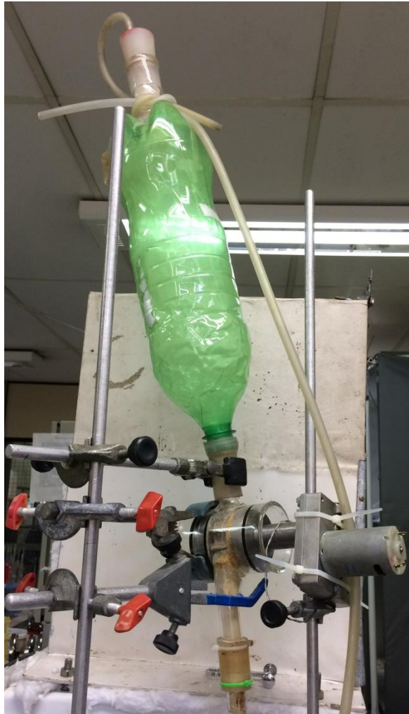
Figura 3.1: Silo de alimentação acoplado à roda dentada. Fonte: acervo pessoal.
