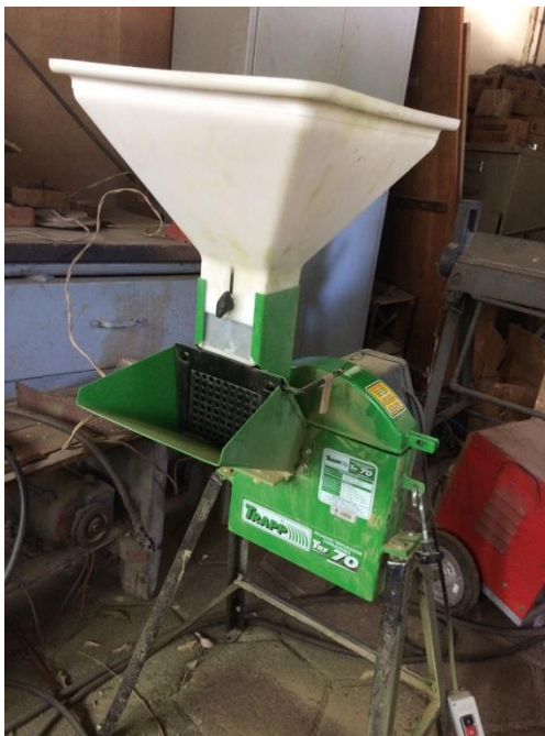
Figura 3.17: Moedor utilizado na primeira moagem de folhas.
