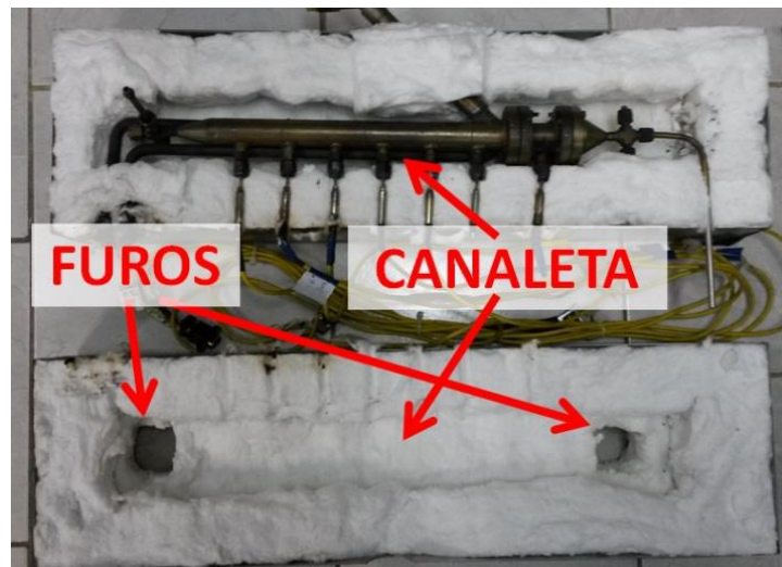
Figura 3.12: Forno de aquecimento do reator. Fonte: Raymundo (2016).
