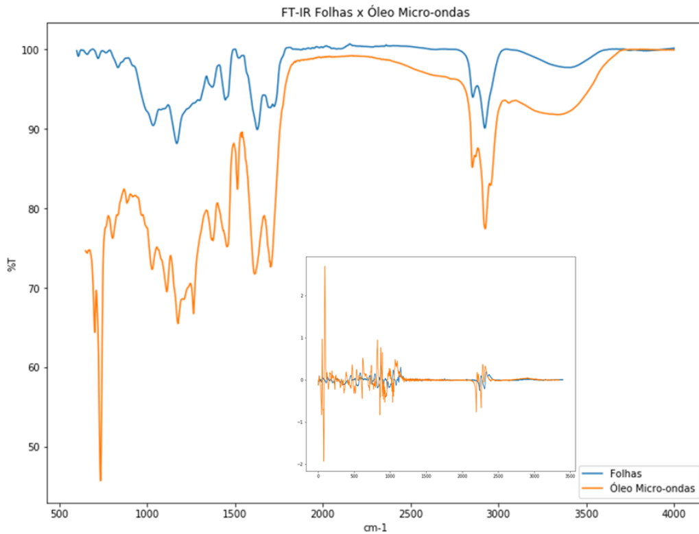
Figura 5.18: FT-IR do bio-óleo obtido com aquecimento por micro-ondas e das folhas secas. No detalhe, a derivada das curvas
