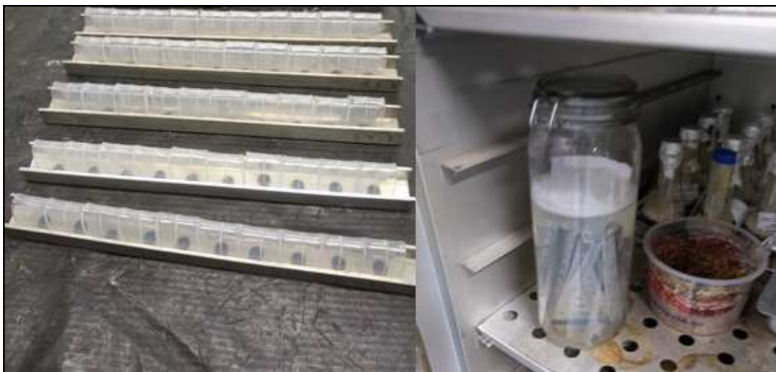
Figura 18 - Acondicionamento dos corpos de prova em estufa para ensaio de stress cracking
