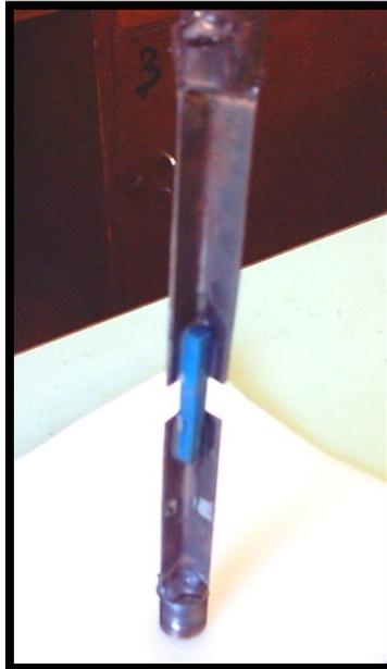
Figura 5: Imagem do Amortecedor Uniaxial.
