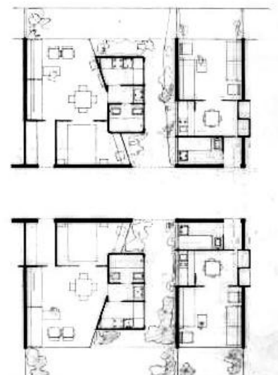
Figura 135: Taba Guaianases. Projeto de Lina Bo Bardi, 1951. Desenho da planta dos apartamentos. Planta de dois tipos de apartamentos separados por corredor. Fonte: ILPMB (documento 019ARQd0163).
