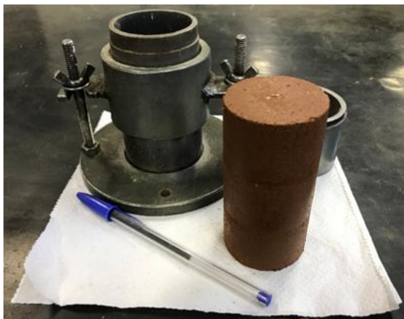
Figura 4.5: Molde tripartido utilizado para moldagem de corpos-de-prova de 5 cm de diâmetro e 10 cm de altura.
