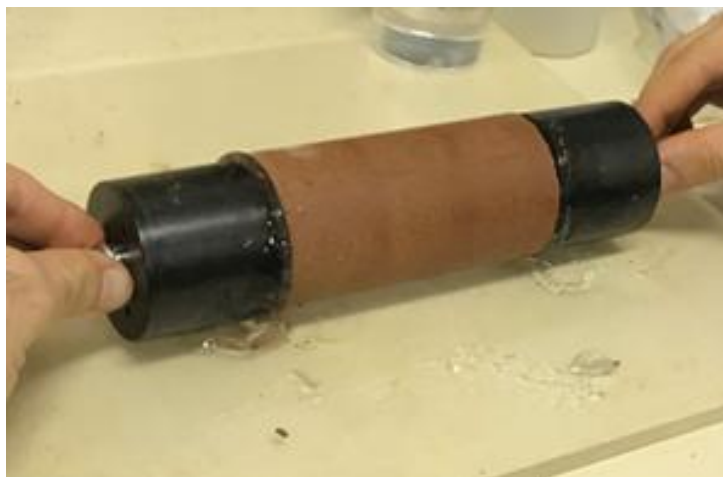
Figura 4.8: Medição do tempo de deslocamento de ondas de compressão.
