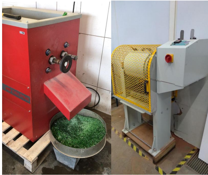
Figura 3.10: Equipamentos utilizados na trituração e moagem do vidro.
