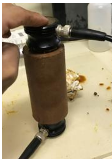
Figura 4.9: Medição do tempo de deslocamento de ondas de cisalhamento.
