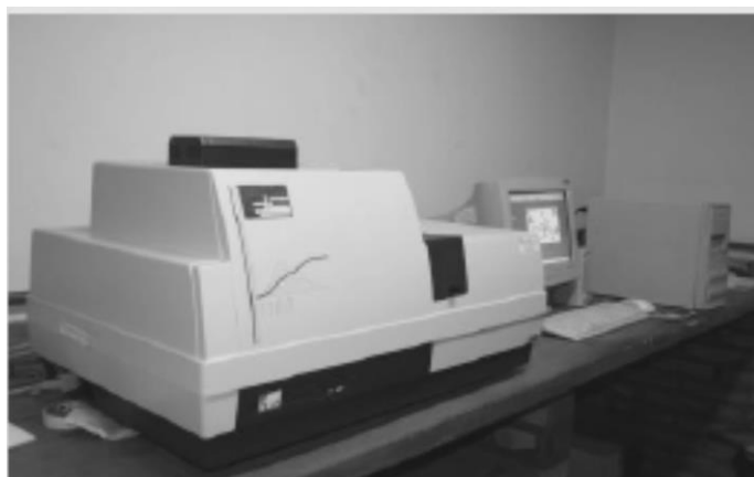
Figura 40. Analisador de partículas a laser utilizado na análise granulométrica dos sedimentos utilizados no leito móvel e, também, na composição das correntes de turbidez.
