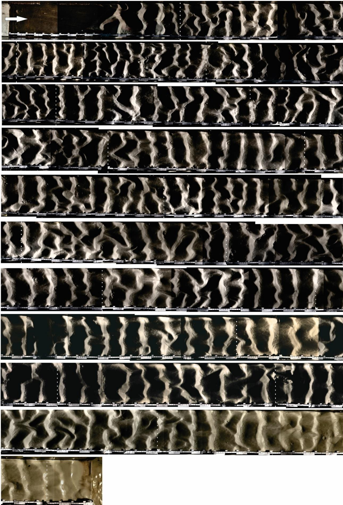
Figura 163. Vista superior das formas de fundo do experimento CSQ3 ( Q= 370 \text{ L min}^{-1} ; Fr_{d,E3}= 1,97 ; \rho_{mist}= 1053,9 \text{ kg m}^{-3} ; \lambda_{1-10 \text{ m}}= 8,0 \text{ cm} ; \lambda_{10-17 \text{ m}}= 8,8 \text{ cm} ).
