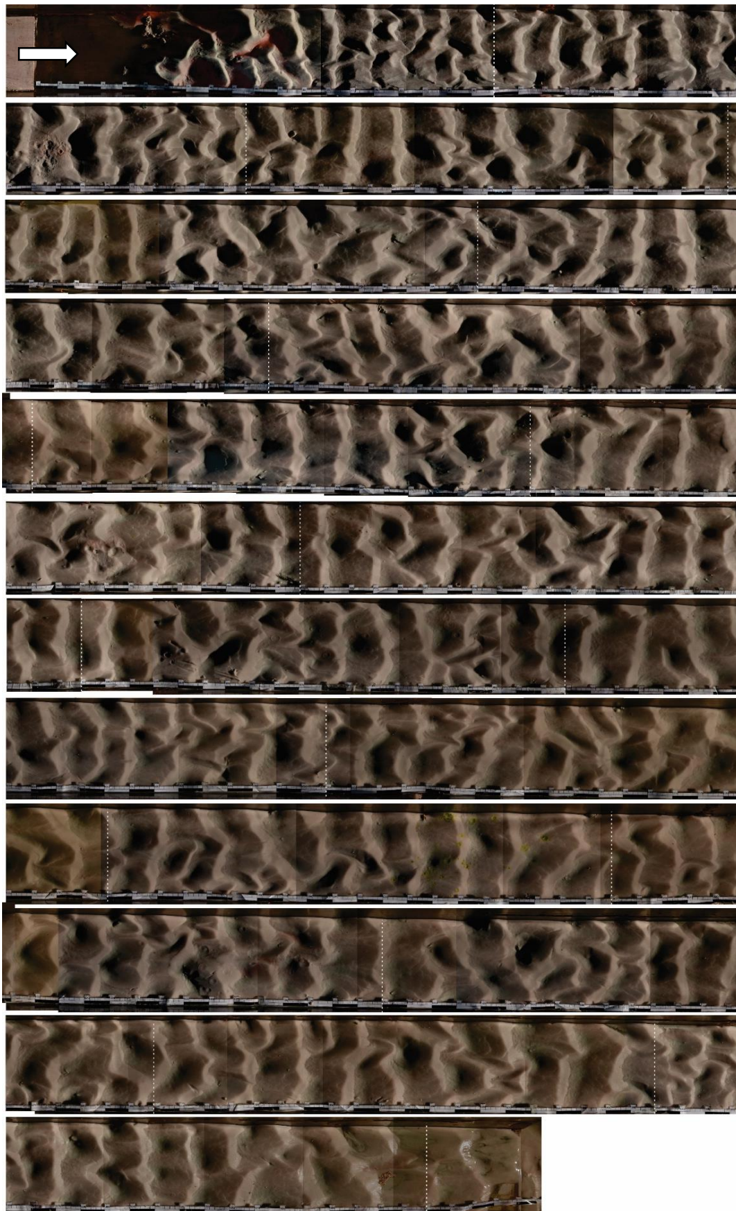
Figura 162. Vista superior das formas de fundo do experimento CSQ2 ( Q= 320 \text{ L min}^{-1} ; Fr_{d,E3}= 1,88 ; \rho_{mist}= 1053,7 \text{ kg m}^{-3} ; \lambda_{1-10 \text{ m}}= 9,0 \text{ cm} ; \lambda_{10-17 \text{ m}}= 8,9 \text{ cm} ).
