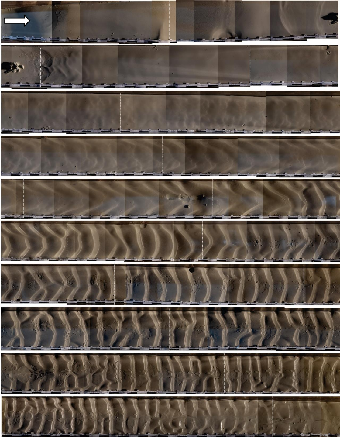
Figura 165. Vista superior das formas de fundo do experimento CTQ2 ( Q= 320 \text{ L min}^{-1} ; Fr_{d,E3}= 1,86 ; \rho_{mist}= 1061,1 \text{ kg m}^{-3} ; \lambda_{5-10 \text{ m}}= 10,5 \text{ cm} ; \lambda_{10-17 \text{ m}}= 7,6 \text{ cm} ).
