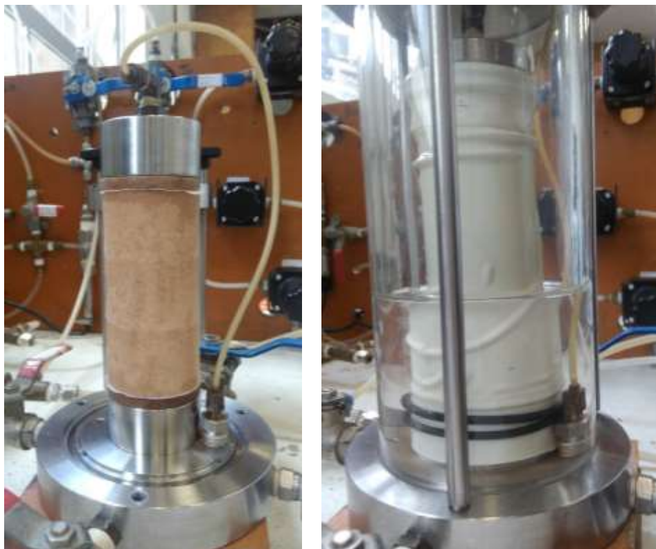
Figura 23 - Instalação da amostra e preenchimento da câmara
