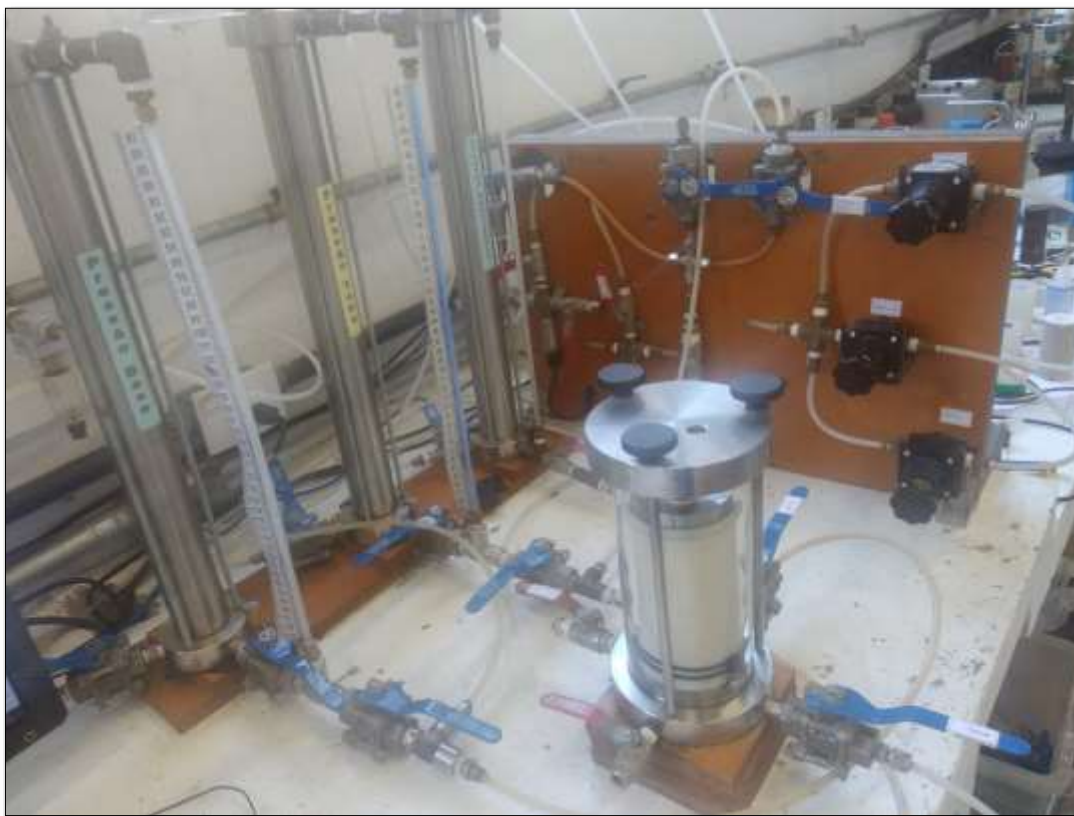
Figura 22 - Permeâmetro - Vista geral
