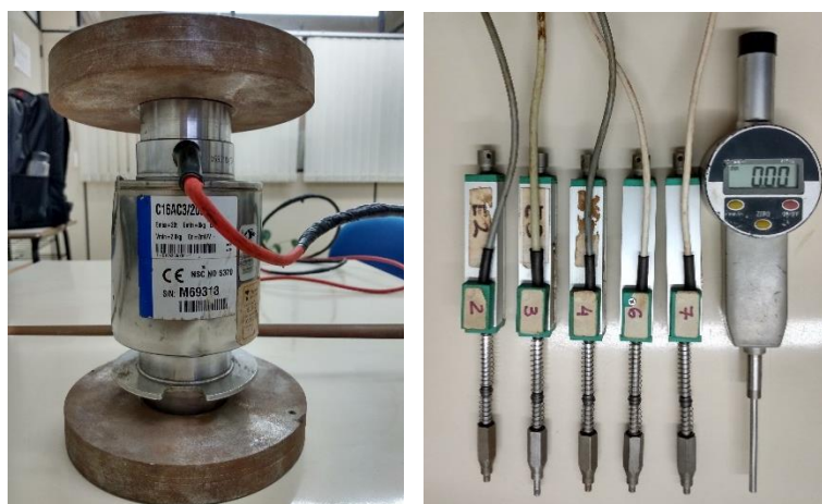
Figura 4.28: Célula de carga e transdutores de deslocamento
