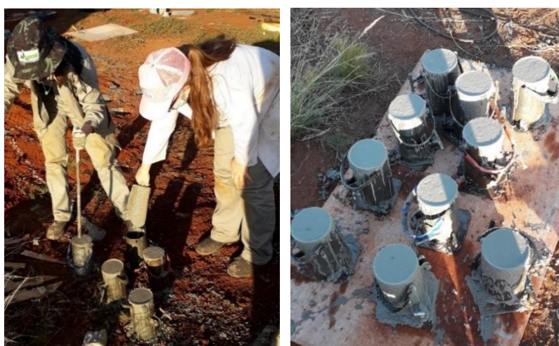
Figura 4.24: Moldagem dos CPs de concreto autoadensável
