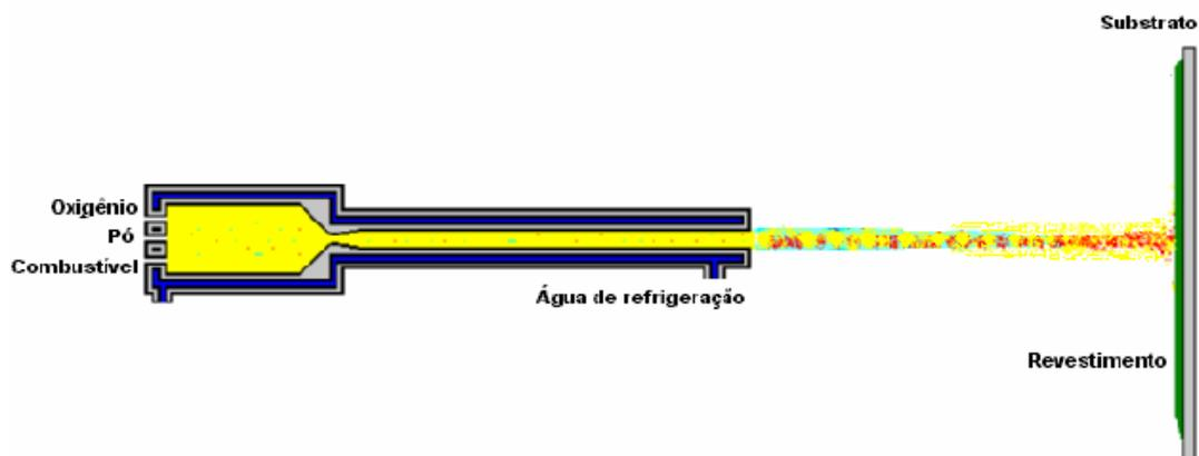
**Figura 37** – Representação esquemática do processo de aspersão térmica hipersônica. Adaptado de (ENGLAND).
