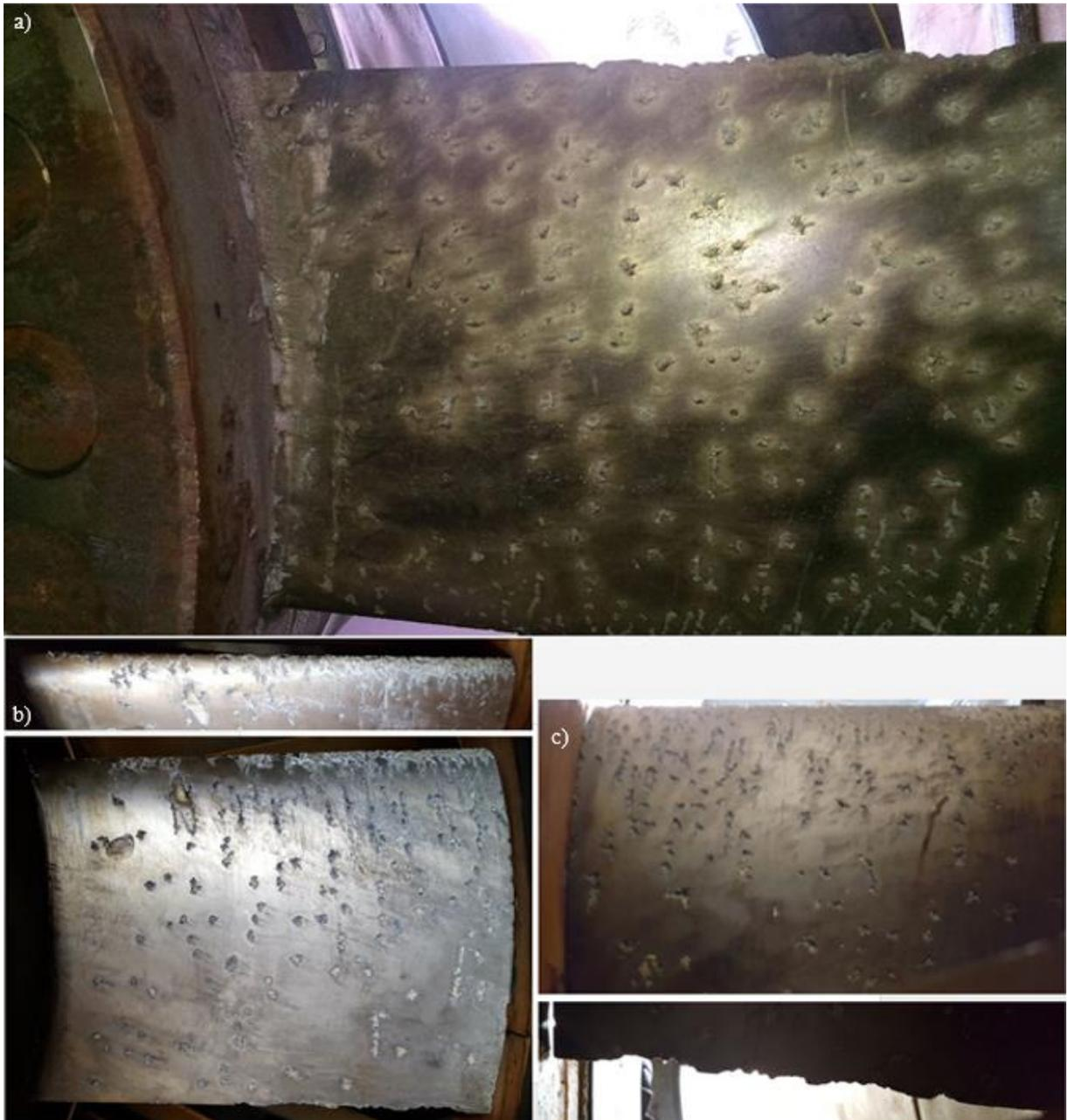
**Figura 13** – Imagens datadas de 2017 mostrando o desgaste nas pás da turbina (a), lado terra com fissuras, cicatrizes de erosão nas bordas de ataque (b) e lado mar com cicatrizes similares ao lado terra (c).
