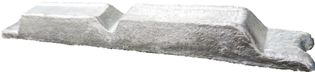
**Figura 51** – Alumínio A356.0 T6/AlSi<sub>7</sub>Mg<sub>0,3</sub> fornecido pela empresa Latasa do Grupo Recicla BR.
