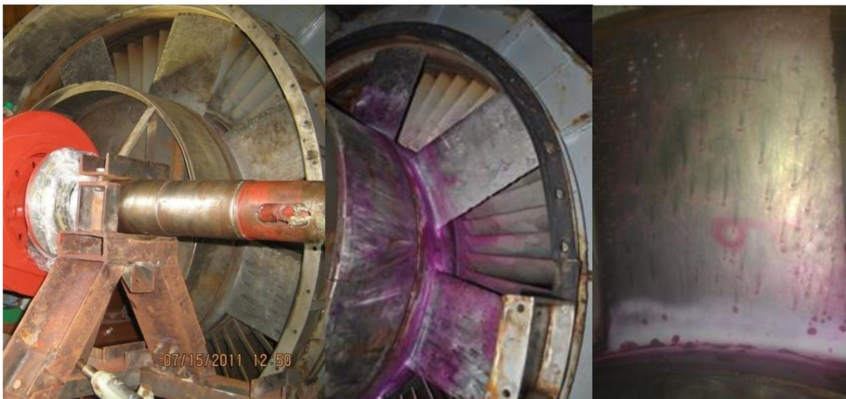
**Figura 12** – Fotografias tiradas em 2011 e 2012 mostrando o desgaste nas pás da turbina. Cortesia do WavEC.
