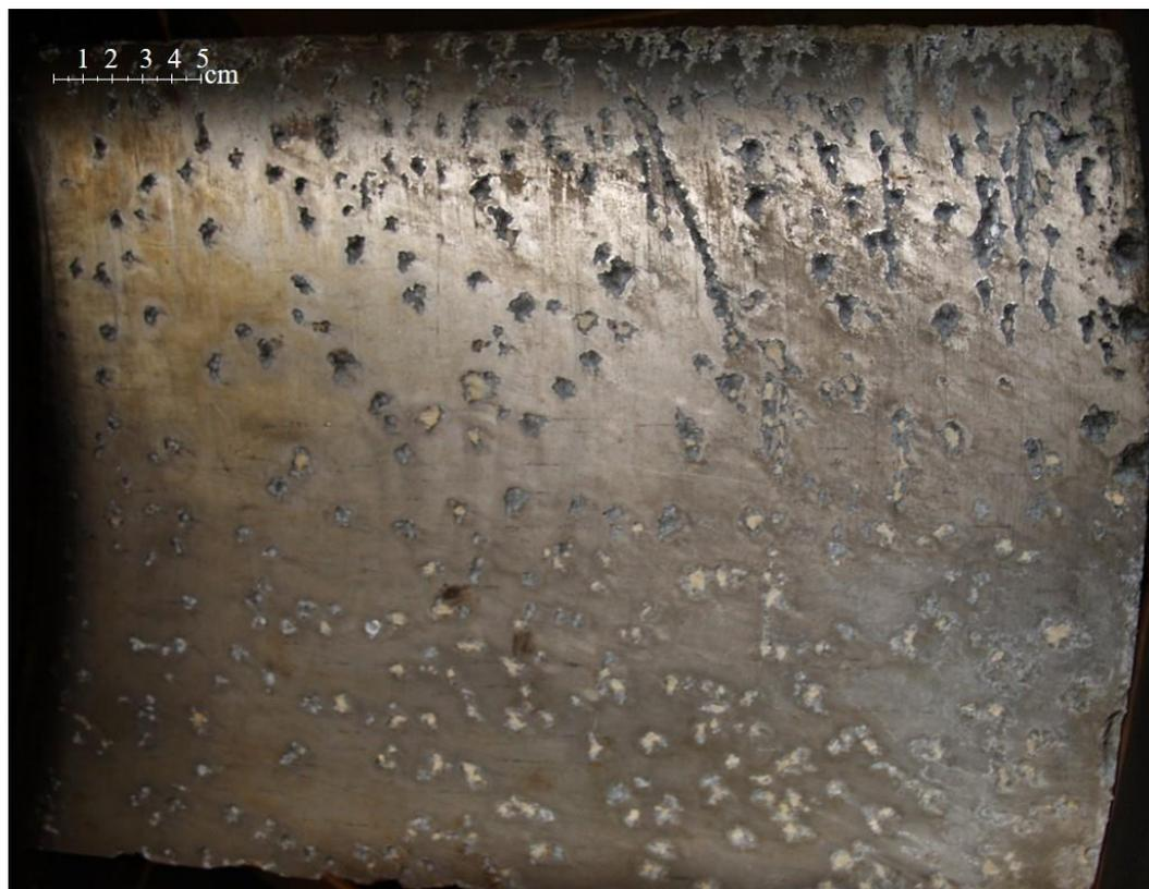
**Figura 65** – Dimensões das rugosidades da pá da turbina da COP, algumas ainda com resina de poliéster aplicada na tentativa de preencher e restaurar a superfície lisa.
