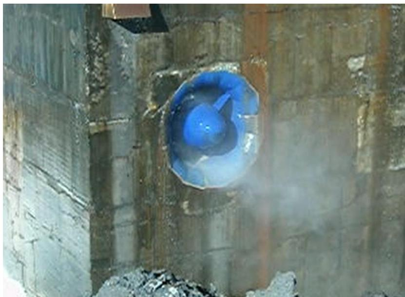
**Figura 11** – Fotografia tirada digitalmente de um vídeo do funcionamento da COP para mostrar o *spray* de água que passou pela turbina e chegou à atmosfera. (WAVEC).
