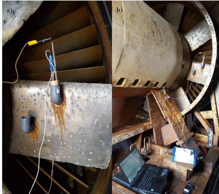
**Figura 49** – Turbina da COP em outubro de 2017: fixação dos componentes para ensaio EIE no lado terra (a) e ensaio de EIE sendo realizado (b).
