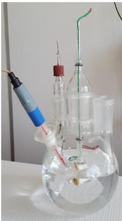
**Figura 58** – Balão de cinco tubuladuras utilizado nos ensaios de EIE.
