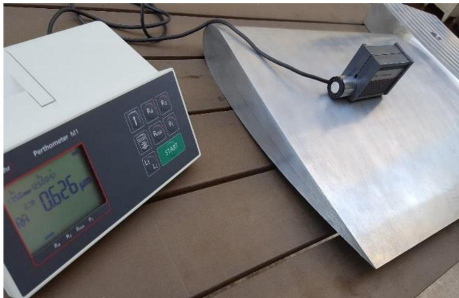
**Figura 48** – Pá da turbina reserva da COP com rugosidade média de 0,626 $\mu$ m.
