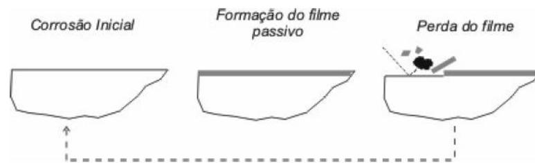
**Figura 34** – Esquema ilustrativo do mecanismo de remoção da película passiva por ação mecânica de partículas abrasivas. (STACHOWIAK; BATCHELOR, 2005).
