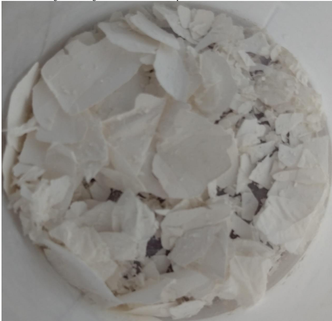
Figura 2. Fotografia das fibras de TiO 2 após o tratamento térmico a 800 °C.
