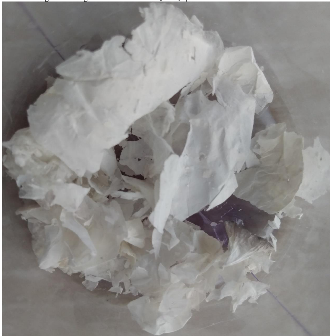
Figura 3. Fotografia das fibras de \text{TiO}_2/\text{WO}_3 após o tratamento térmico a 800\text{ }^\circ\text{C} .
