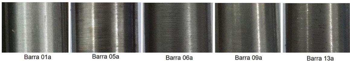
Figura 9: Inspeção visual de uma seção representativa da superfície das barras do grupo IG.
