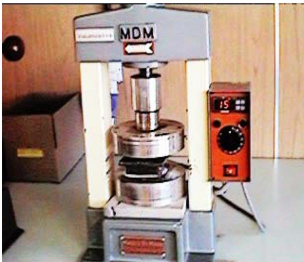
Figura 13: Vulcanizadora de borracha
