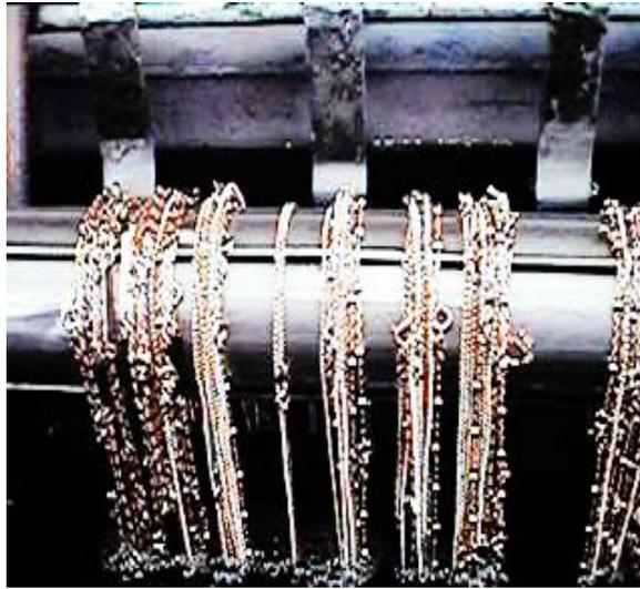
Figura 27: Banho de cobre ácido
