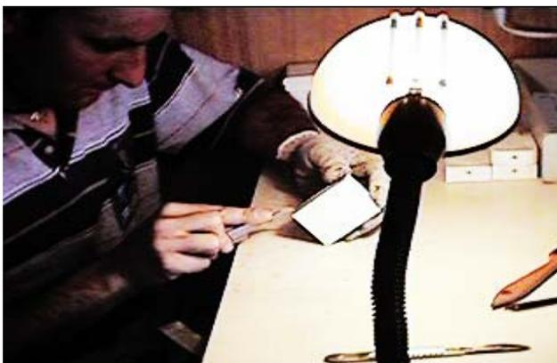
Figura 11: Corte do molde de borracha
