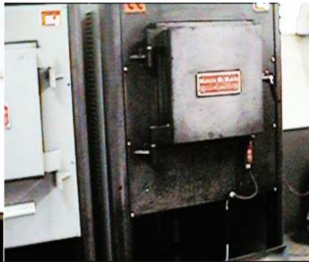
Figura 19: Forno de fundição
