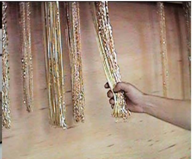
Figura 8: Montagem das correntes para banho
