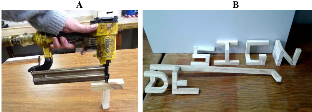
Figura 58 – Equipamentos e objeto: (A) Grampeador pneumático; (B) Processo de montagem
