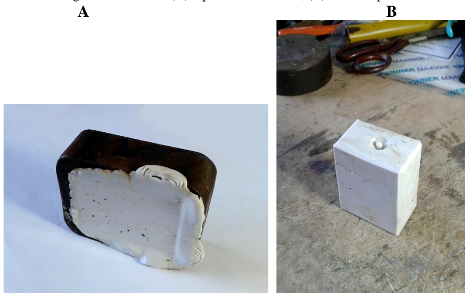
Figura 98 – Molde: (A) Após vulcanizadora; (B) Silicone pronto
