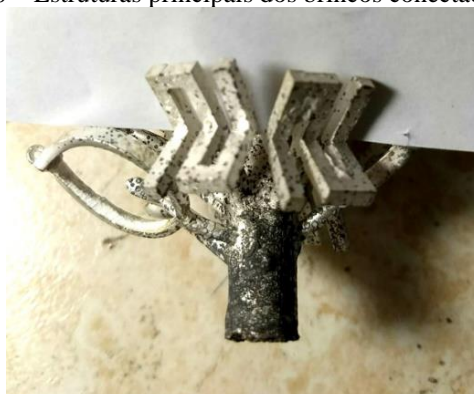
Figura 110 – Estruturas principais dos brincos conectadas à árvore
