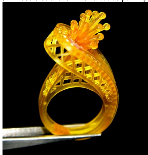
Figura 38 – Modelo de anel em resina obtido por impressão 3D
