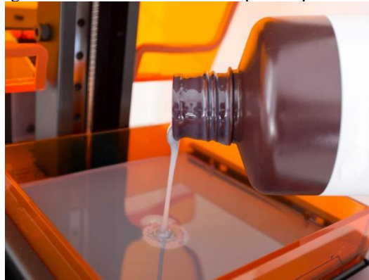
Figura 47 – Resina fotossensível para impressão 3D
