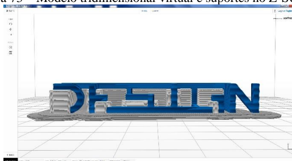
Figura 73 – Modelo tridimensional virtual e suportes no Z-SUITE®
