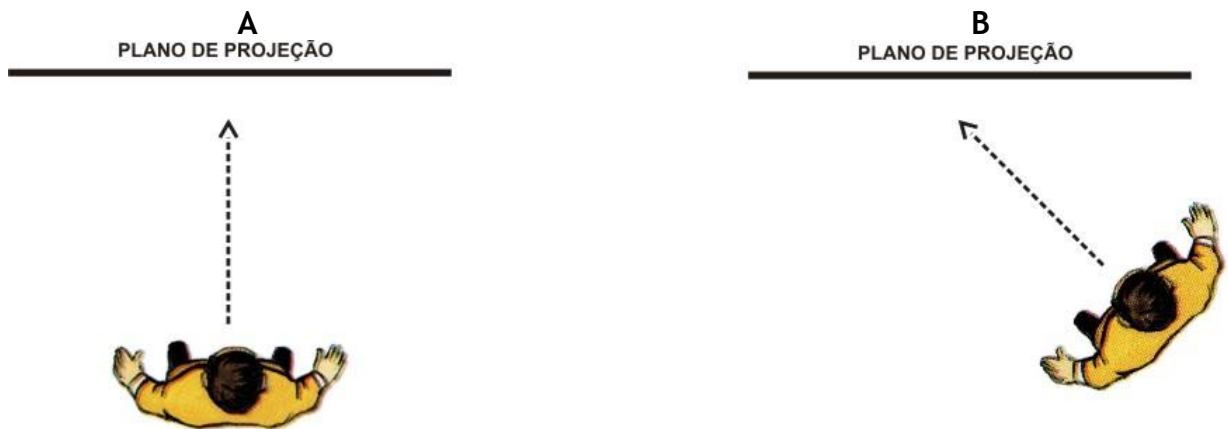
Figura 10 – Planos de projeção: (A) Perpendicular ao eixo do cone de visão; (B) Oblíquo ao eixo do cone de visão
