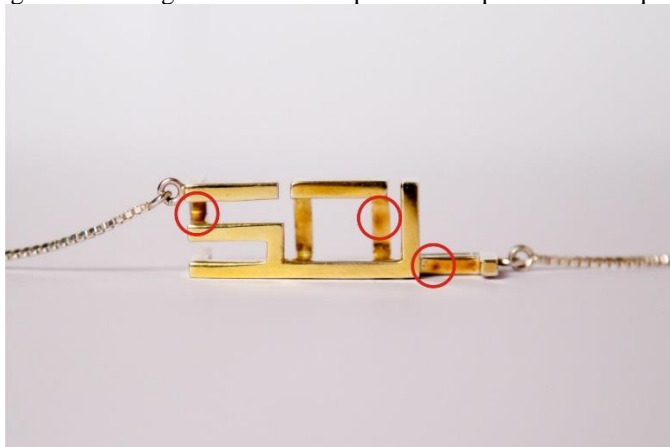
Figura 113 – Regiões escurecidas por falta de polimento adequado
