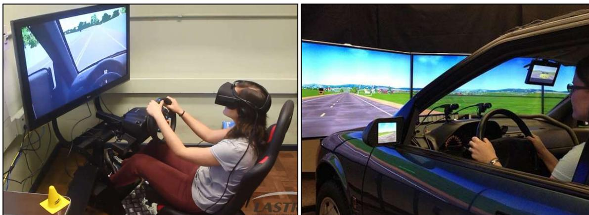
Figura 3 - Simulador de direção com óculos de imersão (esquerda) e telas de projeção (direita)
