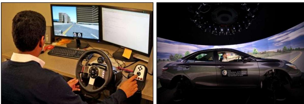
Figura 2 - Simulador de baixo nível de imersão baseado em uma mesa (esquerda) e simulador de alto nível de imersão com cabine realista (direita)
