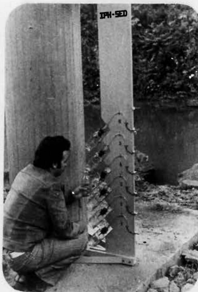
Foto N° 4.- Amostrador de Ní- vel Ascendente (ANA-78) parte da tomada de amostra. Posto-4 / Rio Forquetinha
