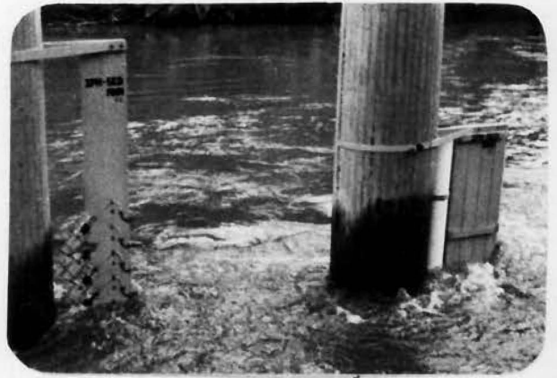
Foto N° 2.- Equipamento automático de coleta de mistura água-sedimento em opera- ção durante uma cheia ( ANA-78 e AND-78)
