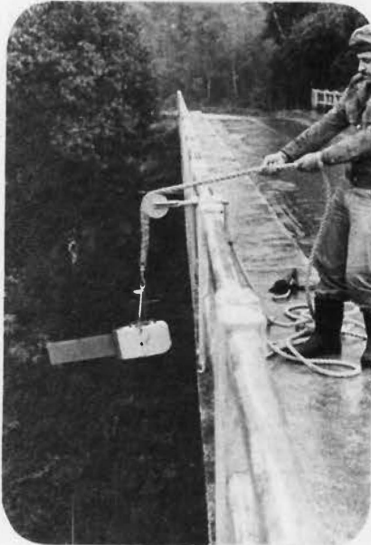
Foto N° 3.- Equipamento utiliza- do pelo observador no programa rotineiro de amostragem de mistu- ra água-sedimento.
