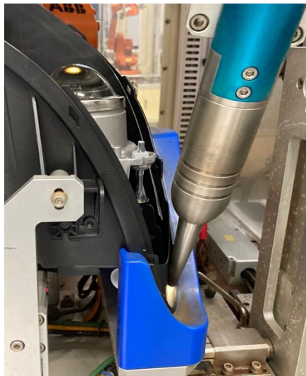
Figura 06: Aplicação do plasma no canal da carcaça.
