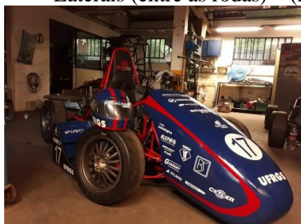
Figura 1 - Carro de corrida da RS Racing UFRGS último modelo com as asas Laterais (entre as rodas) – (Fonte Própria)
