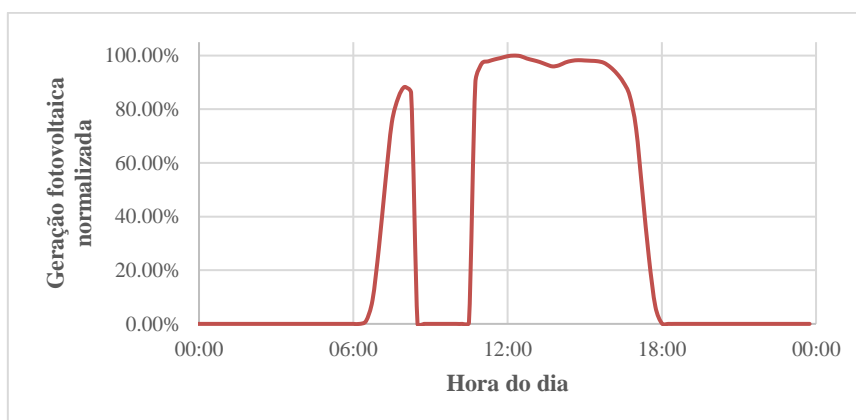
Figura 3.2 - Exemplo de produção fotovoltaica com disponibilidade reduzida.
