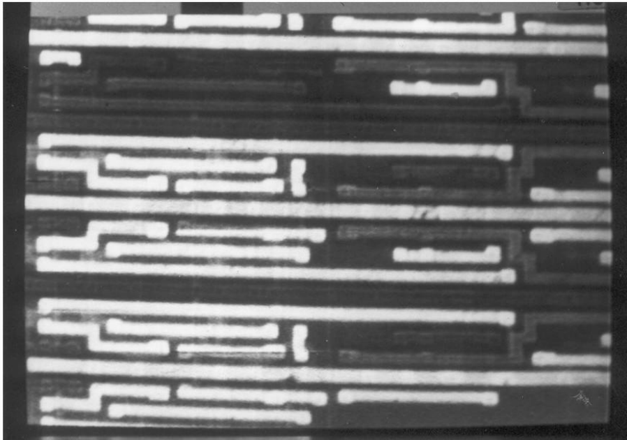
Fotografia 4.22 Registrador deslocador no estado binário 000010 (A=x320, E= 40 \mu m)
