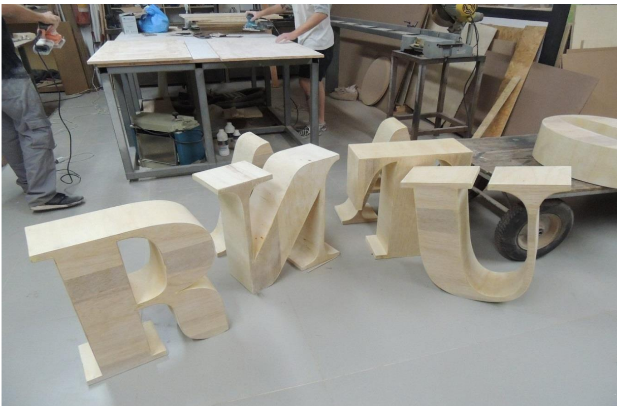
Figura 45: Corte de alta precisão da máquina de fabricação digital CNC Router Bertech.
