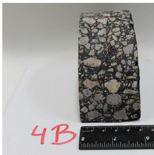
Figura 15 - Exemplo de amostra com faces não paralelas. Fonte: autora.
