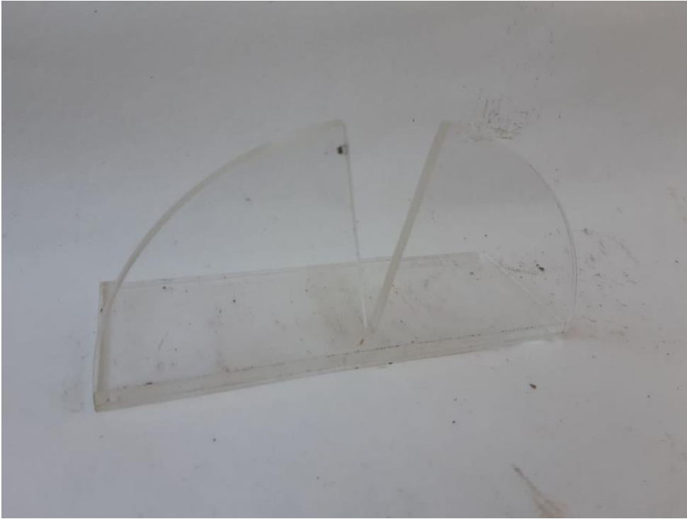
Figura 3 - Aparato de acrílico para validação do ensaio SCB. Fonte: autora.
