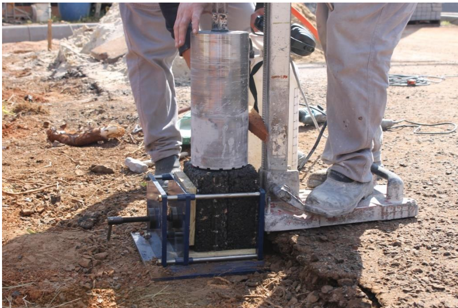
Figura 10 - Suporte utilizado para posicionar as placas no momento da extração com serra copo. Fonte: autora.
