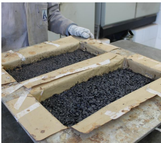
Figura 8 – Placa dentro do molde com os 4cm inferiores moldados. Fonte: autora.
