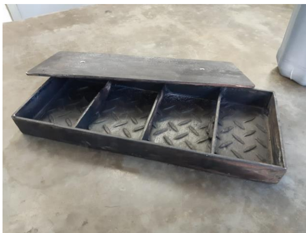
Figura 7 - Espaçador usado na compactação. Fonte: autora.
