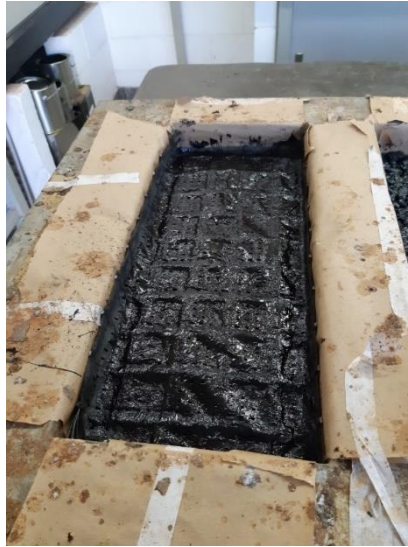
Figura 9 - Placa dentro do molde com os 4 com inferiores moldados. Fonte: autora.
