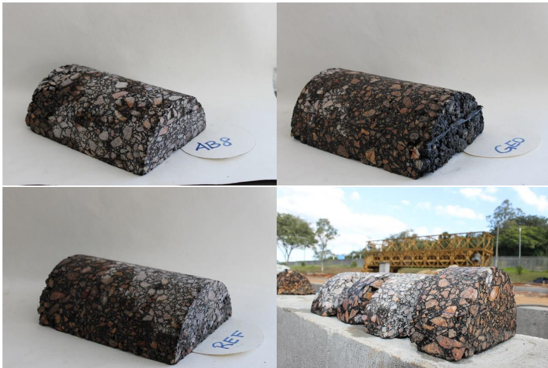
Figura 11 - a) superior à esquerda: cilindro partido ao meio extraído da placa com mistura AB8; b) superior à direita: cilindro partido ao meio extraído da placa com Geogrelha; c) inferior à esquerda: cilindro partido ao meio extraído da placa de referência d) inferior à direita: corpos de prova serrados a partir dos cilindros partidos ao meio. Fonte: autora.
