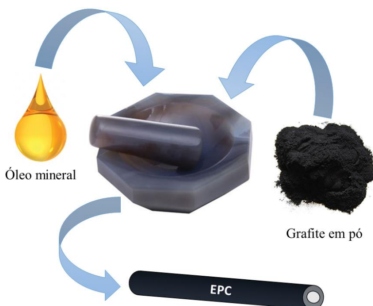
Figura 2. Representação esquemática do preparo de um eletrodo de CPE.
